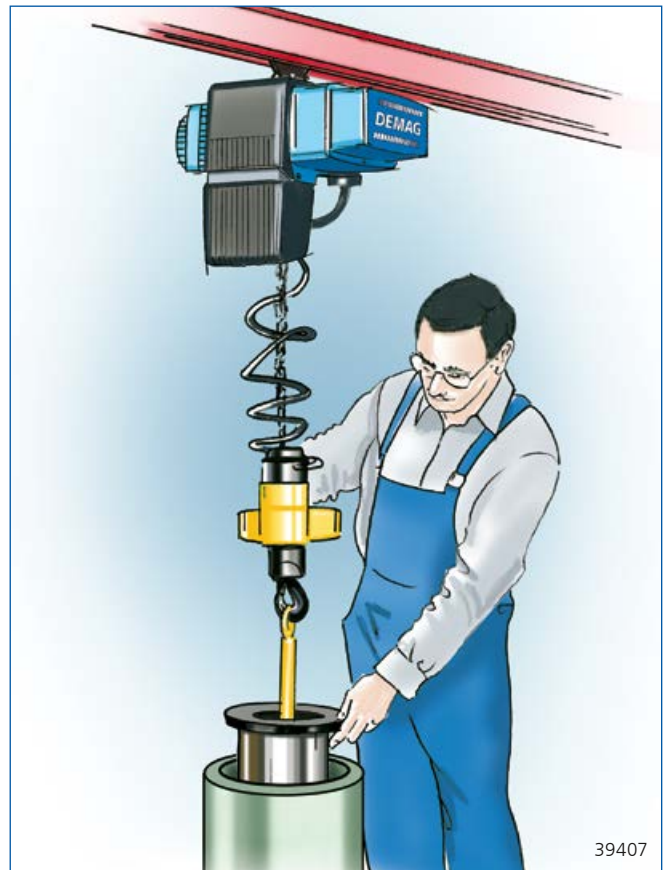
Positionnement en douceur et très précis d'une bobine sur un dérouleur
