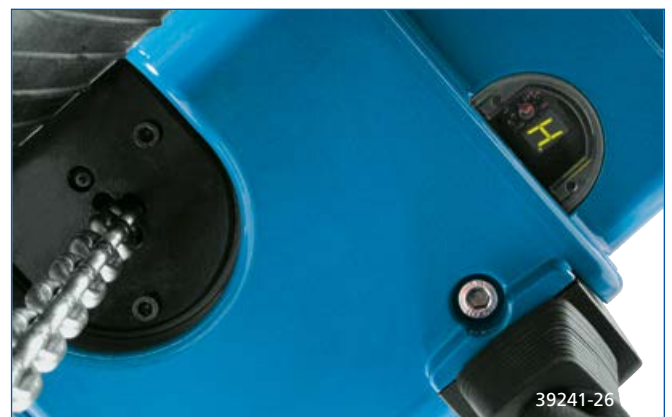
Compteur d'heures de service / interface de diagnostic
